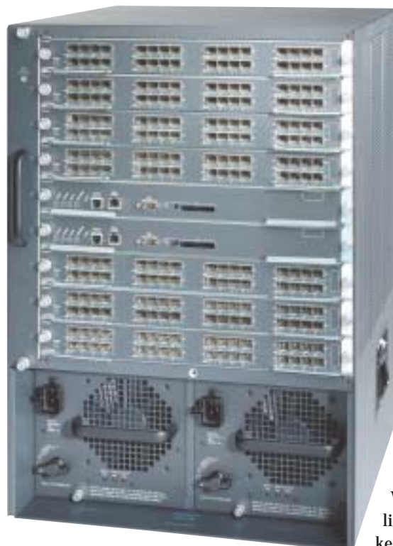
ZENTRALE. Der modulare Fabric Director Switch Cisco MDS 9509 verfügt über sieben Slots für Fibre Channel Switch-Module. Die Virtualisierung im Switch erlaubt kurze, redundante Datenpfade und reduziert die Anzahl der Boxen
